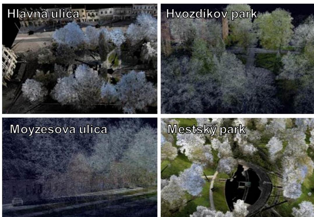
**Obr. 5.** Ukážka výsledného mračna bodov v prirodzených farbách z pozemného laserového skenovania štyroch lokalít v rámci záujmového územia pre jeden dátum. Biele body sú zachytené laserovým skenovaním ale v zákryte pre fotografiu.
